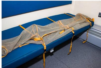
**Шаг 2.** Закрепите **верхние** стропы на верхней полке так, чтобы хвостик стропы смотрел **вверх**. У крайних строп снизу возле стены будут фастексы для крепления двери.
